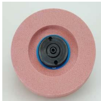
Namontovaná upínací příruba brusného kotouče
