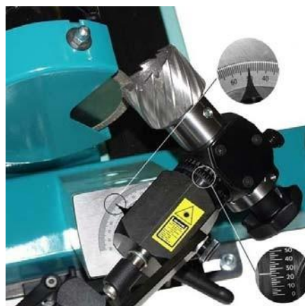
Stupnice na sloupku
